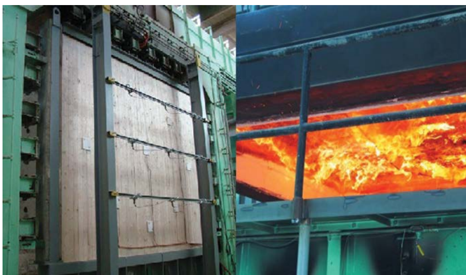
Figura 4. Assajos de panells de CLT fusta contralaminada. Foto: FP Innovations Canada.
