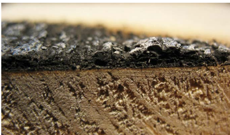
Efecte d'una pintura intumescent en contacte amb el foc. Foto: Teknos
